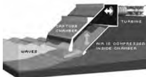
Figuras 10, 11 y 12: Esquema básico de una instalación OWC para el aprovechamiento energético de las olas
